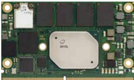
Das congatec SMARC 2.0 Modul ist mit Intel Atom, Celeron und Pentium Prozessoren (Codename Apollo Lake) bestückt und auch für den Outdoor-Einsatz in Smart City Applikationen geeignet.
