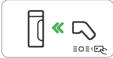
Ladekabel an der Ladestation anstecken.
